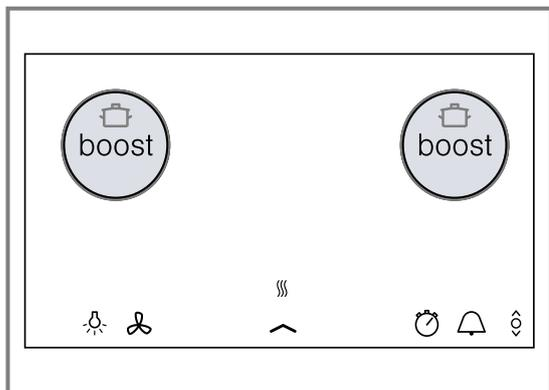
Se a função estiver ativa e selecionar um segundo disco do mesmo lado da superfície de cozedura, o aparelho desativa a função. O aparelho regula automaticamente a potência de cozedura 9.0.
