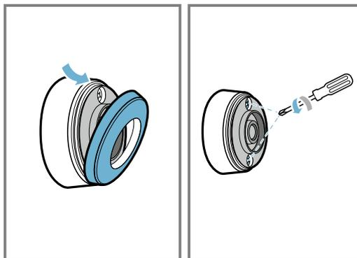
2. Abra a tampa do sensor de cozedura e retire a pilha do interior da base.
