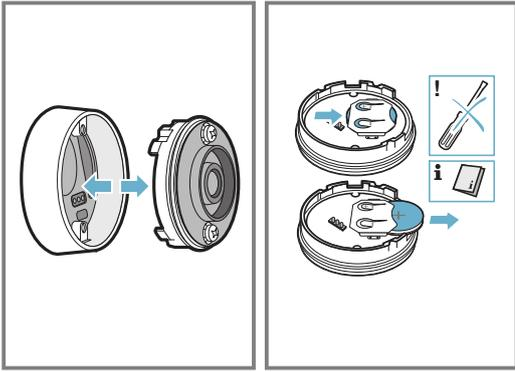
3. Coloque a pilha nova e siga as instruções relativas à polaridade da pilha. Utilize apenas pilhas de alta qualidade do tipo CR2032.
