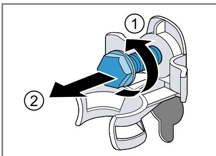
3. Priključni kabel odstranite iz držala.
