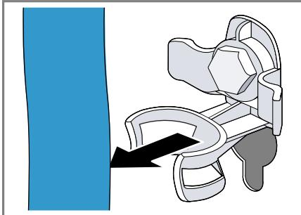
2. Vse vijake 4 transportnih varoval odvijte z vijačnim ključem dim. 13 ① in jih odstranite ②.
