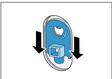
**Opomba:** Da vstavite transportna varovala v aparat pred transportom, opravite te korake v obratnem vrstnem redu.
