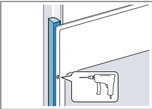
4. Het apparaat met adequate schroeven bevestigen.
