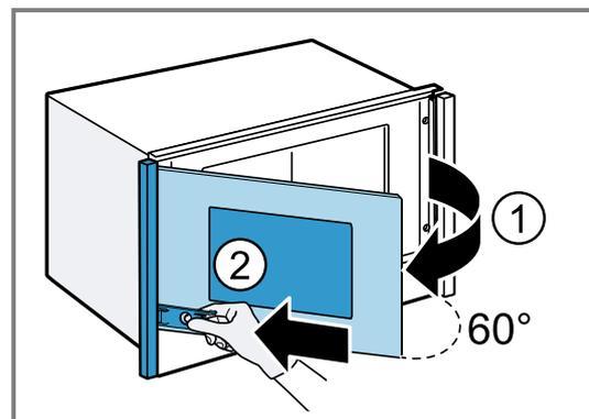
2. Per staccare i pannelli, chiudere lo sportello dell'apparecchio ① e spingere l'elemento di fissaggio sullo sportello e in direzione del pannello ②.
