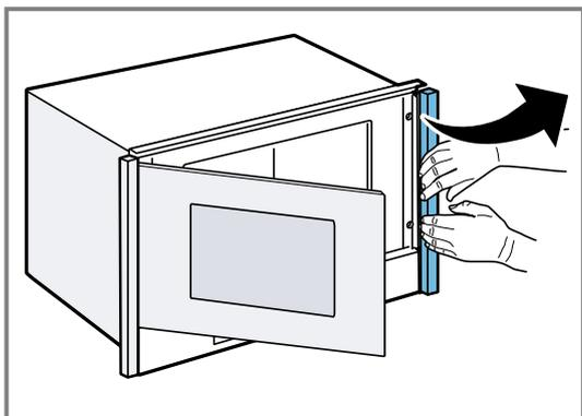
4. Si les éléments de fixation se sont détachés lors du démontage des bandeaux, refixez-les. Pour ce faire, accrochez l'élément de fixation en bas et appuyez en haut jusqu'à ce qu'il soit en contact.
