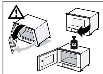
1. Ouvrez la porte de l'appareil à 60° ② et insérez un élément de fixation directement au-dessus du bandeau de commande entre la porte de l'appareil et le bandeau ①.
