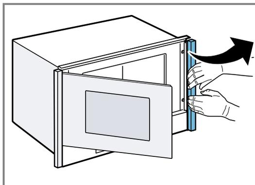
4. Nel caso in cui gli elementi di fissaggio si siano allentati durante lo smontaggio dei pannelli, serrarli nuovamente. Allo scopo, agganciare in basso l'elemento di fissaggio e premere in alto finché non è posizionato.
