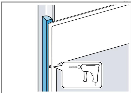
4. Fixez l'appareil avec une vis adéquate.
