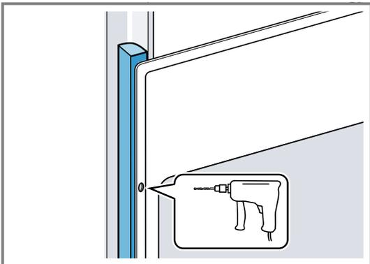
4. Das Gerät mit adäquater Schraube befestigen.
