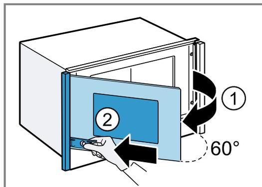
2. Om de platen te verwijderen, de apparaatdeur sluiten ① en daarbij het bevestigingselement op de apparaatdeur en in de richting van de afdekking duwen ②.
