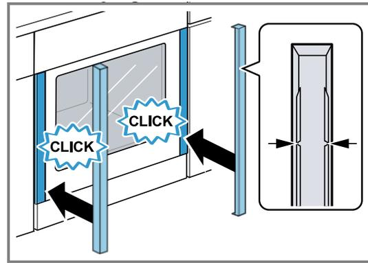
La freccia all'interno dei pannelli deve indicare in alto. Posizionare la scanalatura dei pannelli sulla relativa nervatura trasversale in corrispondenza della parte di fissaggio rossa.
