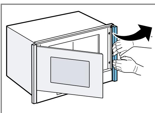
4. Falls sich bei der Demontage der Blenden die Befestigungselemente gelöst haben, diese wieder befesti-
