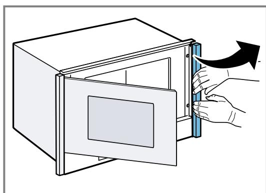
4. Wanneer bij de demontage van de afdekkingen de bevestigingselementen los zijn geraakt, deze weer bevestigen. Daarvoor het bevestigingselement aan de onderzijde inhangen en boven aandrukken totdat deze er tegen aan ligt.
