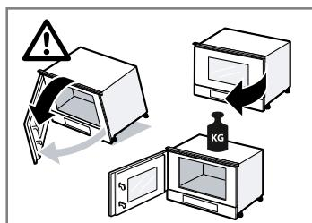
1. De apparaatdeur  $60^\circ$  openen ① en een bevestigingselement direct boven de bedieningsplaat tussen de apparaatdeur en de afdekplaat schuiven ②.
