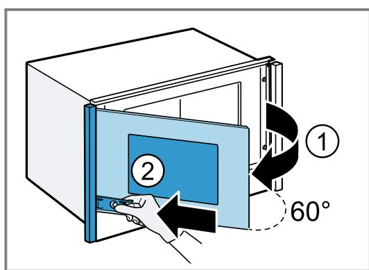
2. Om de platen te verwijderen, de apparaatdeur sluiten ① en daarbij het bevestigingselement op de apparaatdeur en in de richting van de afdekking duwen ②.
