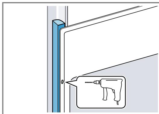
**4. Fixez l'appareil avec une vis adéquate.**
