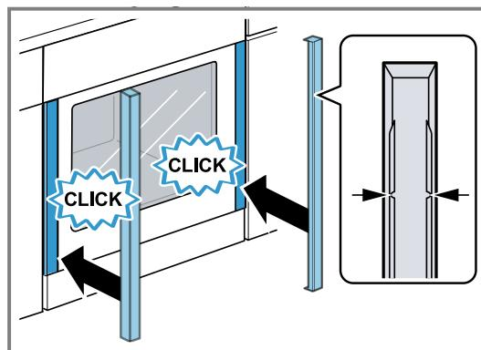
La flèche à l'intérieur des bandeaux doit être orientée vers le haut.
