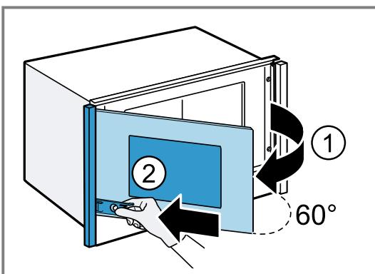
2. Um die Blende zu lösen, die Gerätetür schließen ① und dabei das Befestigungselement an die Gerätetür und Richtung Blende drücken ②.
