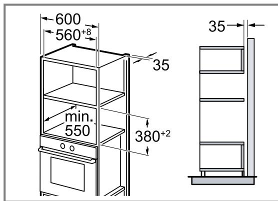
Encastrez l'appareil uniquement à une hauteur permettant de retirer sans problème les accessoires.
