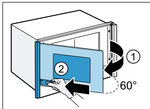
2. Pour détacher le bandeau, fermez la porte de l'appareil ① ② en appuyant sur l'élément de fixation contre la porte de l'appareil et en direction du bandeau.
