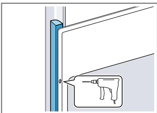
4. Das Gerät mit adäquater Schraube befestigen.
