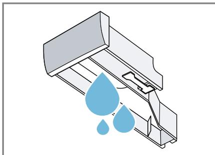
7. Pulire l'unità della pompa con un panno umido.
