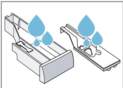
9. Asciugare e inserire il cassetto del detersivo, il coperchio e l'unità della pompa.
