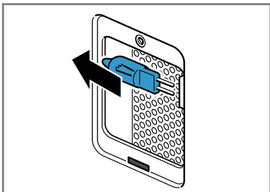
5. Die neue Halogenlampe einsetzen.
