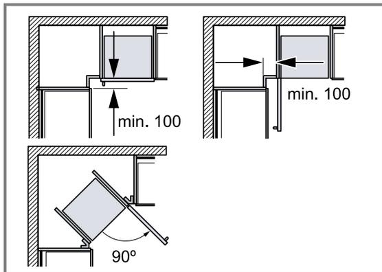
Damit die Gerätetür geöffnet werden kann, beim Eckeinbau die Mindestmaße berücksichtigen.
