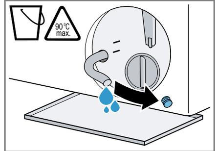
8. Appuyez sur le bouchon de fermeture.
