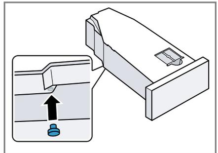
3. Limpe o filtro no depósito da água de condensação.
