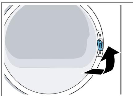
4. Aparafuse a cobertura do sistema de bloqueio da porta.
