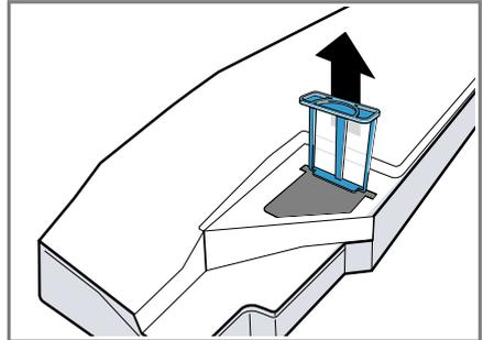
3. Limpe o filtro com água quente corrente ou na máquina de lavar louça.
