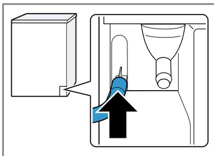
3. Empurrar a mangueira de escoamento da água sobre o bocal, até ao batente.
