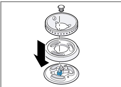
Die Ausrichtung von Brennerkopf und Brennerring ist egal.
