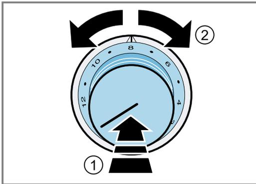
Zur Optimierung des Überzündens zwischen den Brennerkreisen geht der Brenner beim Umschalten von der Kochstufe 3 auf die Kochstufe 4 oder eine höhere Kochstufe kurzzeitig auf die maximale Leistung.
