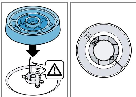
4. Die Rastnase am Brennerring in der Aussparung am Brennerkopf einrasten.
