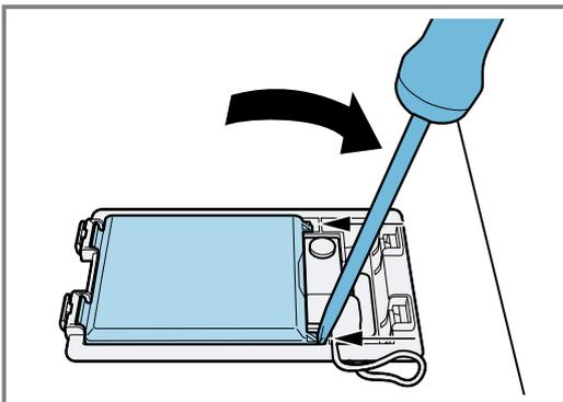
4. Solte o parafuso de fixação e levante a braçadeira com a ajuda de uma chave de fendas.
