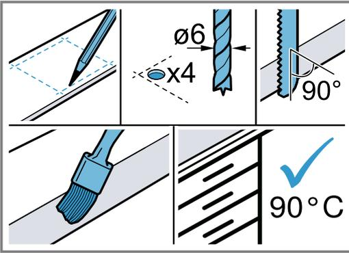
6. Remova pó e resíduos dos trabalhos de abertura do nicho. Sele as superfícies de corte à prova do calor e da água.
