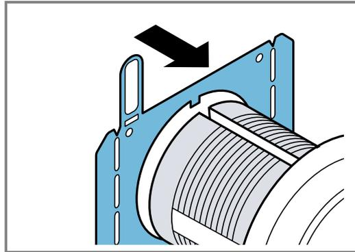
8. No lado de trás do comando, aperte a porca de retenção com a ferramenta de montagem fornecida.
