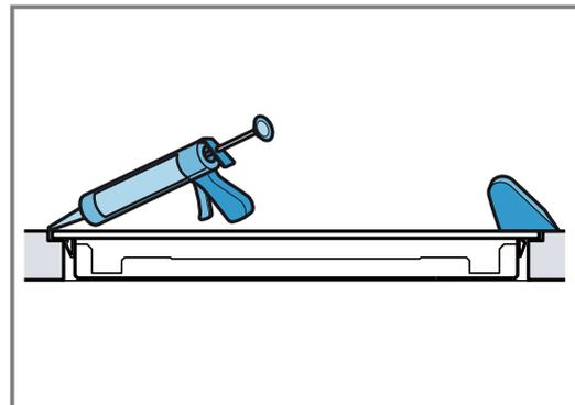
Nas bancadas de pedra natural, uma cola de silicone inapropriada provocará descolorações permanentes.
