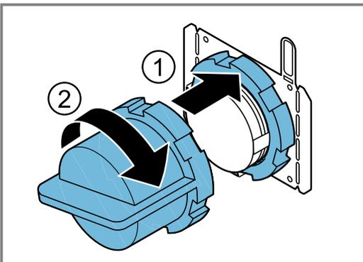
7. Den Bedienknebel exakt in Nullstellung ausrichten.
