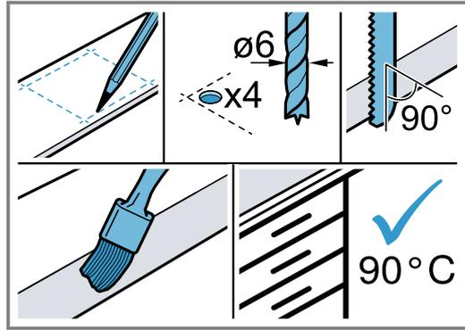
6. Staub und Rückstände der Ausschnittarbeiten entfernen. Die Schnittflächen hitzebeständig und wasserdicht versiegeln.
