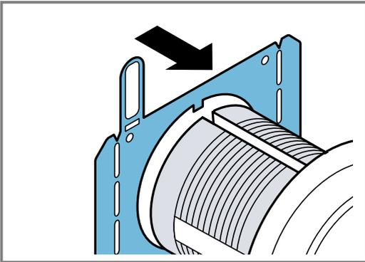
6. An der Rückseite des Bedienknebels die Haltemutter mit dem beiliegenden Montagewerkzeug festschrauben.
