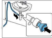
Zajistěte místo připojení hadicovou sponou (12–22 mm). Odtokovou hadici upevněte pomocí držáku hadice ve výšce minimálně 80 cm a maximálně 100 cm.
