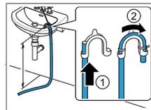
Odtokovou hadici úplně prostrčte kolenem → *Strana 12* a upevněte ji pomocí spojovacího materiálu. Kolo upevněte ve výšce maximálně 100 cm.
