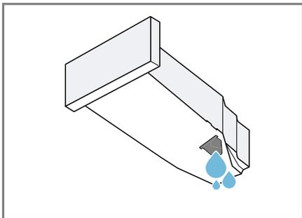
Pravidelně kontrolujte filtr nádržky na kondenzovanou vodu → *Strana 48* a znečištěný filtr vyčistěte. Dbejte na to, aby byla před spuštěním provozu spotřebiče nádržka na kondenzovanou vodu zasunutá.
