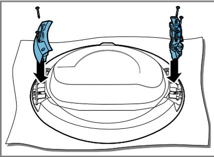
Dbejte na to, abyste přitom neuskřípli nebo nepoškodili těsnění dvířek.
