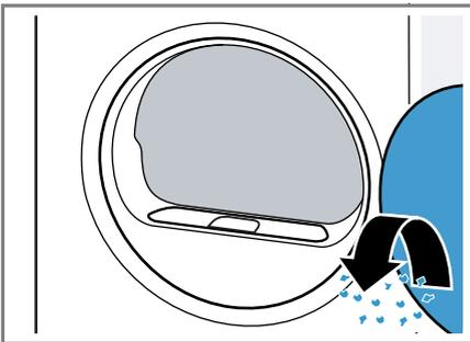
3. Das zweiteilige Flusensieb entfernen.
