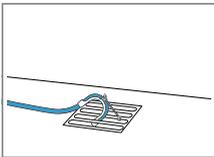
Den Wasserablaufschlauch komplett durch den Krümmen → Seite 12 schieben und mit dem Befestigungsmaterial fixieren. Den Krümmen am Gully befestigen.
