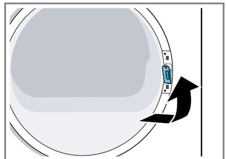
4. Die Abdeckung der Türverriegelung anschrauben.
