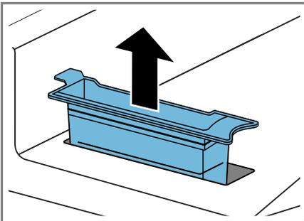
2. Den Filter mit fließendem, warmen Wasser oder in der Geschirrspülmaschine reinigen.
