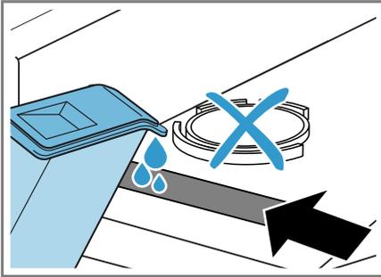
Prüfen Sie regelmäßig den Filter des Wassertanks und reinigen Sie einen verunreinigten Filter.
