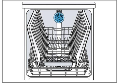
Damit der Sprühstrahl alle Teile erreichen kann, ordnen Sie maximal 2 Backbleche und 2 Gitter wie abgebildet ein.
