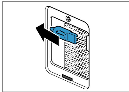
5. Die neue Halogenlampe einsetzen.
