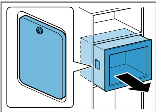
3. Die Schraube an der Lampenabdeckung auf der linken, äußeren Seitenwand lösen und die Lampenabdeckung abnehmen.
