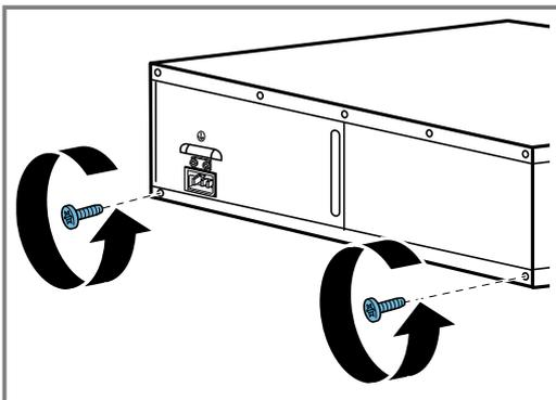
6. Die beiden Metallhalter an der Geräterückseite mit den beiden Schrauben festschrauben.
