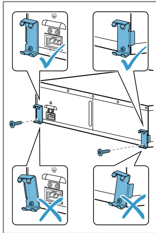
7. Das Gerät in das Einbaumöbel einschieben und prüfen, ob der Kippschutz einrastet.
