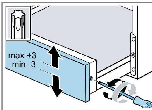
3. Die Frontblende nach oben oder unten ausrichten. Maximal sind  $-3$  bis  $+3$  mm Ausrichtung möglich.
