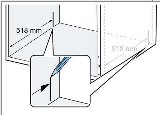
2. Die beiden Winkel an der Markierung ausrichten.
