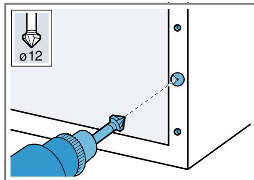
6. Die 4 Bohrungen für die Anschlagpuffer bohren.
