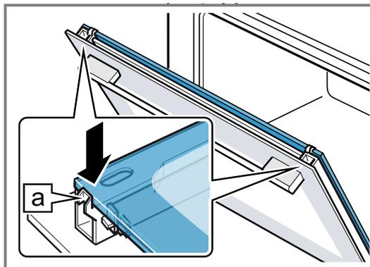
5. Die Abdeckung aufsetzen und andrücken, bis sie hörbar einrastet
