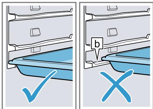
3. Den Dampfbehälter mittig greifen und einschieben.
