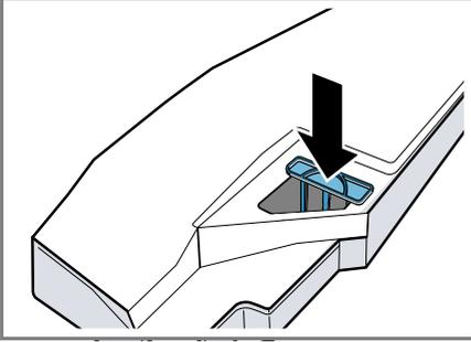
5. Mettez en place le réservoir d'eau de condensation.
