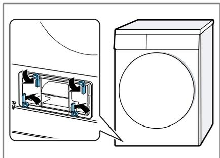
3. Retirez le couvercle de l'échangeur thermique par la poignée.
