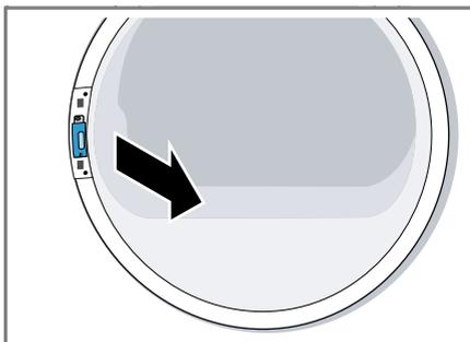
3. Insérer le système de verrouillage de hublot sur le côté opposé.
