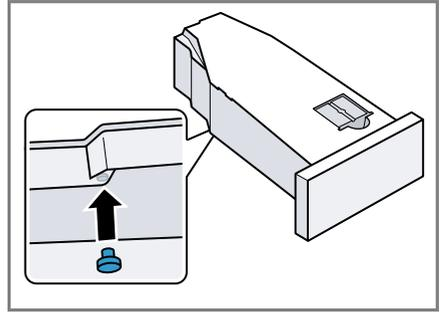
3. Nettoyer le filtre du réservoir d'eau de condensation.
