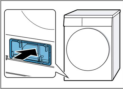
2. Fermez le levier du couvercle de l'échangeur thermique.
