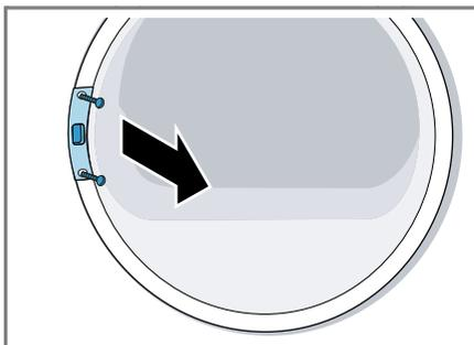
2. Retirer le système de verrouillage de hublot.
