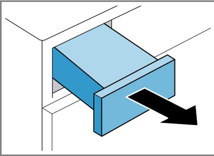
2. Vider le réservoir d'eau de condensation.
