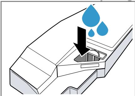
Дръжте напълнения резервоар за кондензна вода водоравно, за да не изтече течност.
