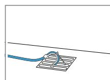
Избутайте маркуча за мръсната вода напълно през и фиксирайте с крепежен материал. Закрепете дръжката върху канала.
