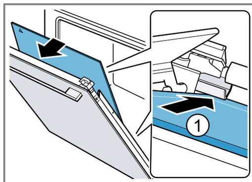
2. **Nota:** O vidro intermédio posiciona-se automaticamente através do movimento rotativo do suporte distanciador.
