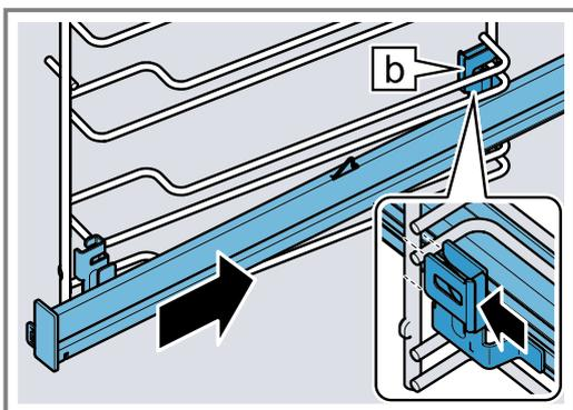
3. Mantenha **PUSH** pressionado **1** e vire a calha extensível para dentro **2**, até que o suporte **a** esteja engatado na haste inferior.
