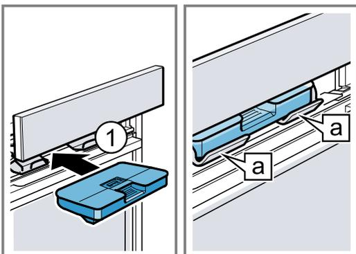
9. Empurre o painel de comandos lentamente para baixo e, em seguida, pressione-o para trás, até que o painel de comandos esteja completamente fechado.
