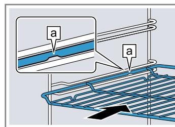
Tabuleiro P. ex., tabuleiro universal ou tabuleiro Insira o tabuleiro com a chanfradura
