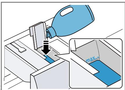
Ao encher, não exceda a marcação do nível de enchimento máximo.
