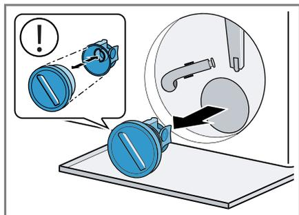
2. Limpe o interior, a rosca da tampa da bomba e a carcaça da bomba.
