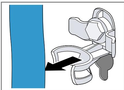
2. Solte todos os parafusos dos 4 dispositivos de segurança para transporte com uma chave SW13 ① e retire-os ②.
