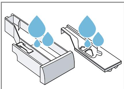
9. Secar bem e colocar a gaveta para detergente, a tampa e a unidade da bomba.
