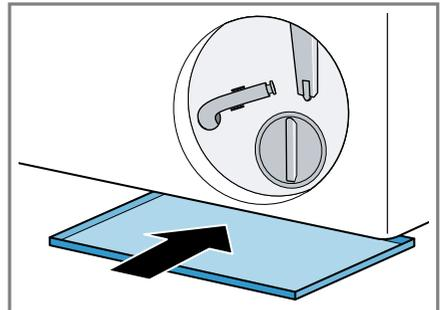
6. Den Entleerungsschlauch aus der Halterung nehmen.
