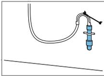
Den Wasserabflussschlauch mit einem Krümmer fixieren und sichern.
