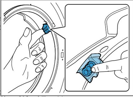
4. Die Gummimanschette außen und innen mit einem feuchten Tuch reinigen und trocken wischen.
