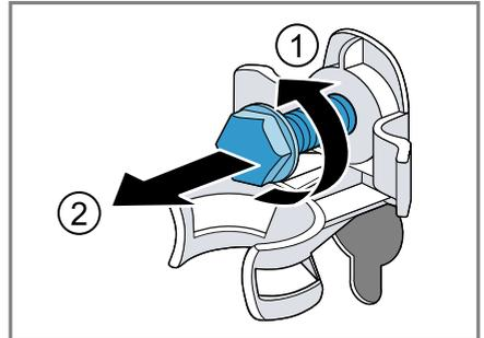
3. Die Netzanschlussleitung von der Halterung entfernen.
