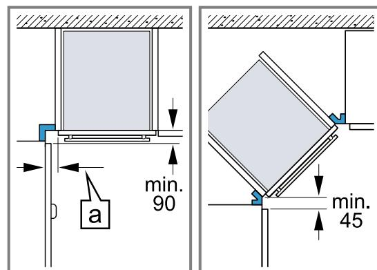
Houd om ervoor te zorgen dat de ovendeur kan worden geopend, bij de hoekinbouw de minimum afmetingen aan. De maat **a** is afhankelijk van de dikte van het meubelfront en de greep.
