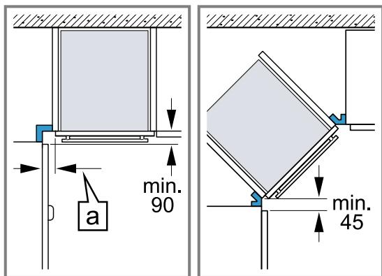
Damit die Gerätetür geöffnet werden kann, beim Eckeinbau die Mindestmaße berücksichtigen. Das Maß **a** ist abhängig von der Dicke der Möbelfront und dem Griff.
