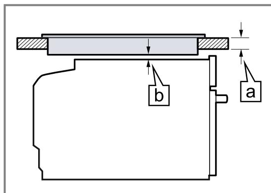
Op basis van de vereiste minimale afstand **b** wordt de minimale dikte van het werkblad berekend **a**.
