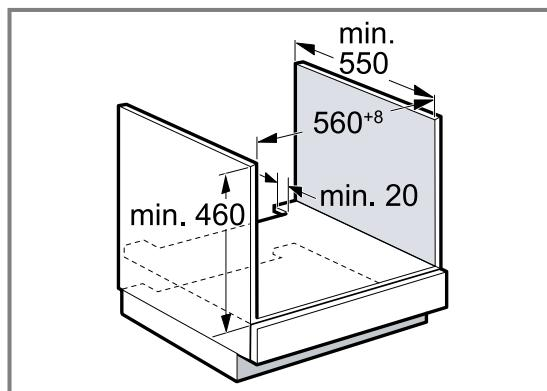
Le plan de travail doit être fixé sur le meuble d'encastrement.
