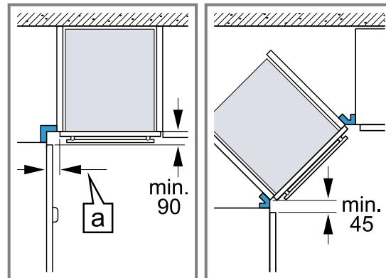
Per permettere l'apertura dello sportello, tenere conto delle dimensioni minime del montaggio angolare. La misura **a** dipende dallo spessore del frontale del mobile e della maniglia.
