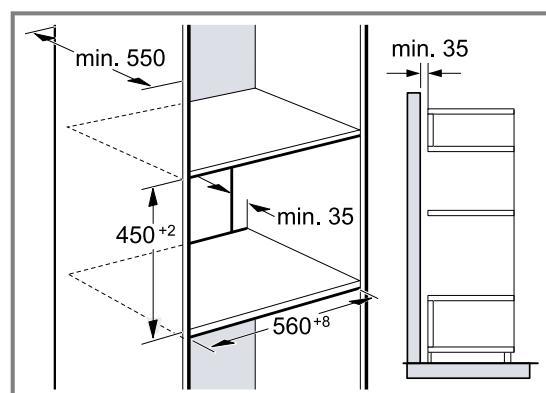
Si le meuble haut possède un panneau arrière en plus des panneaux arrière préfabriqués, celui-ci doit être levé.
