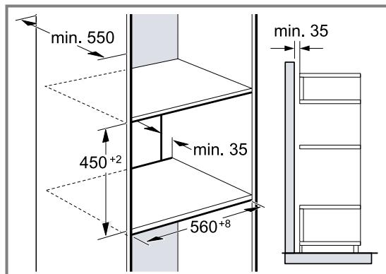
Se oltre ai pannelli posteriori dell'elemento, il mobile alto ha un ulteriore pannello posteriore, quest'ultimo deve essere rimosso.
