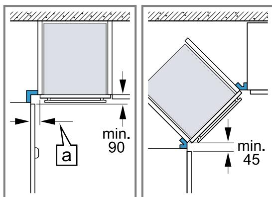
Afin de pouvoir ouvrir la porte de l'appareil, respectez les dimensions minimales en cas d'installation dans un angle. La dimension **a** dépend de l'épaisseur de la façade du meuble et de la poignée.
