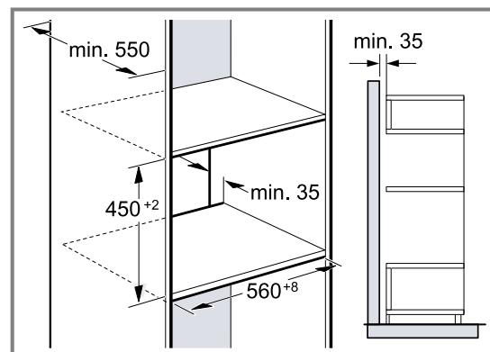
Wenn der Hochschrank zusätzlich zu den Element-Rückwänden eine weitere Rückwand hat, muss diese entfernt werden.
