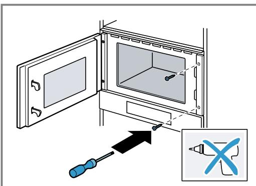
5. Просверлите отверстия для винтового крепления в стенке мебели со стороны петель.
