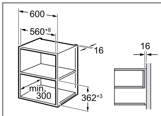
Encastrez l'appareil uniquement à une hauteur permettant de retirer sans problème les accessoires. Retirez les pieds.
