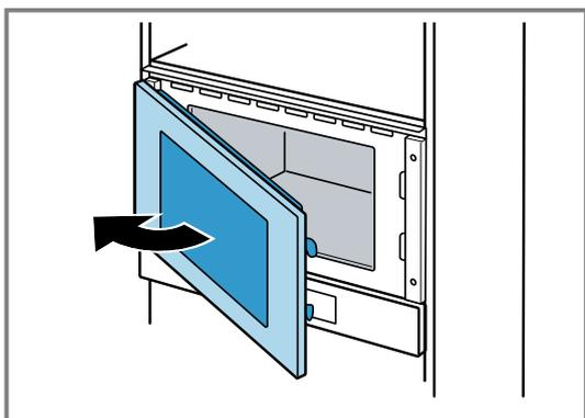
4. Schroef het apparaat op de tegenoverliggende zijde van de scharnieren op het meubel vast.
