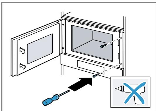
5. Preforare i fori per il collegamento a vite sul lato delle cerniere del mobile.
