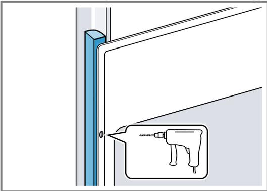
4. Het apparaat met adequate schroeven bevestigen.
