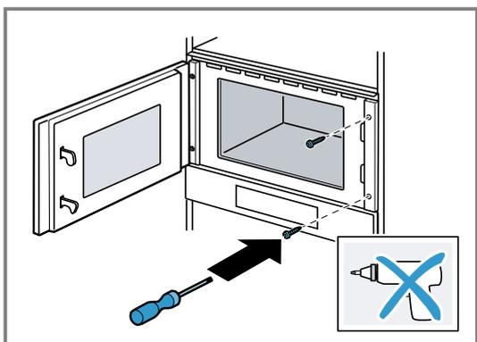
5. Die Bohrungen für die Verschraubung auf der Seite der Scharniere am Möbel vorbohren.
