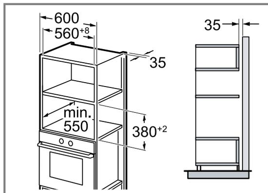
Encastrez l'appareil uniquement à une hauteur permettant de retirer sans problème les accessoires. Réglez les pieds.
