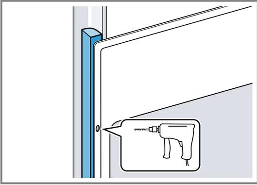
4. Das Gerät mit adäquater Schraube befestigen.
