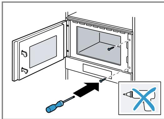
5. De gaten voor het bevestigen aan de kant van de scharnieren in het meubel voorbereiden.
