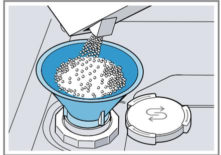
Den Vorrats­behälter komplett mit Spezi­alsalz füllen. Das Wasser im Vorrats­behälter wird verdrängt und läuft ab.
