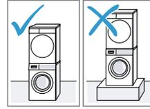
Este aparelho só deve ser colocado numa coluna de lavar-secar com o kit de ligação original do fabricante da máquina de secar.
