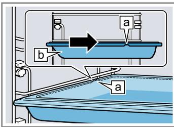
3. Pour installer les accessoires à hauteur d'encastrement avec les rails télescopiques, sortez ces derniers.
