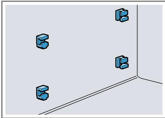
1. Enfiler les fixations à l'avant avec le crochet en haut dans le trou rond et les incliner légèrement ①.
