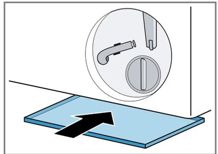
6. Den Entleerungsschlauch aus der Halterung nehmen.
