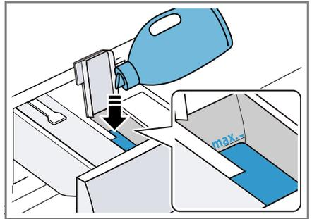
Überschreiten Sie beim Füllen nicht die Markierung des Maximalfüllstands.
