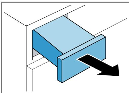
6. Riempire il contenitore dell'acqua di condensa con ca. 1 ½ l di acqua del rubinetto tiepida.
