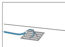
Spostare completamente il tubo flessibile di scarico dell'acqua attraverso il e fissare con il materiale apposito.
