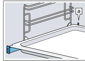
**Remarque :** Repoussez les rails télescopiques dans le compartiment de cuisson en exerçant une légère pression.
