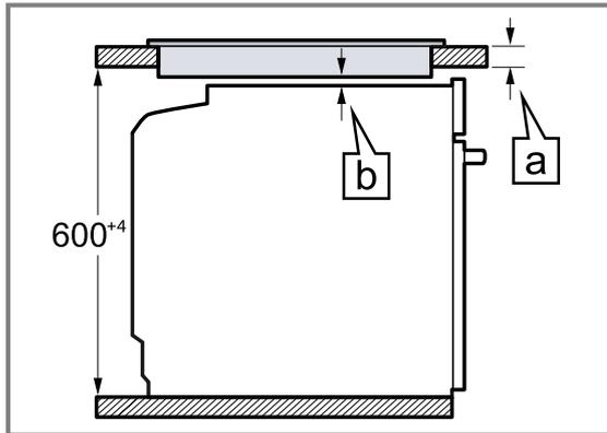
En raison de la distance minimale nécessaire  $\text{[a]}$  l'épaisseur minimale du plan de travail qui en découle est  $\text{[a]}$ .
