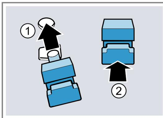
3. Accrocher les fixations arrière avec le crochet dans le trou supérieur ① et les pousser dans le trou inférieur ②.
