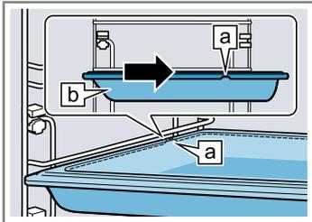
Posez l'accessoire sur les rails télescopiques insérés.
