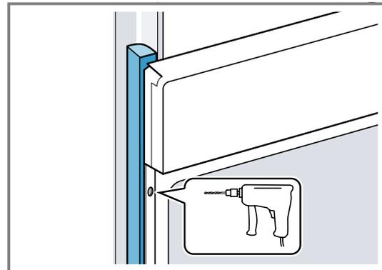
4. Fixez l'appareil avec une vis adéquate.
