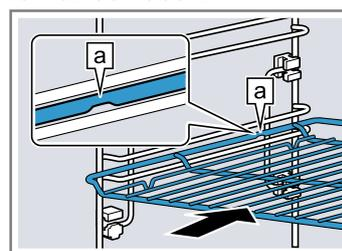
Blech Das Blech mit der Abschrägung
