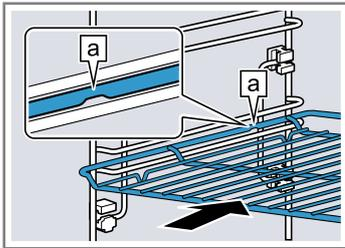
**Blech** Das Blech mit der Abschrägung
