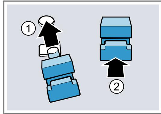
3. Die hinteren Halterungen mit dem Haken in das obere Loch einhängen ① und in das untere Loch eindrücken ②.
