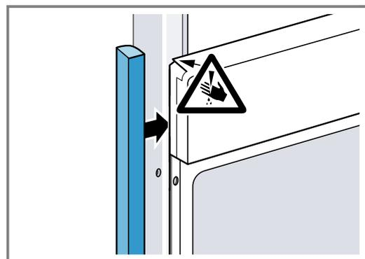
2. Aluprofile vorbohren, um eine Schraubverbindung herzustellen.
