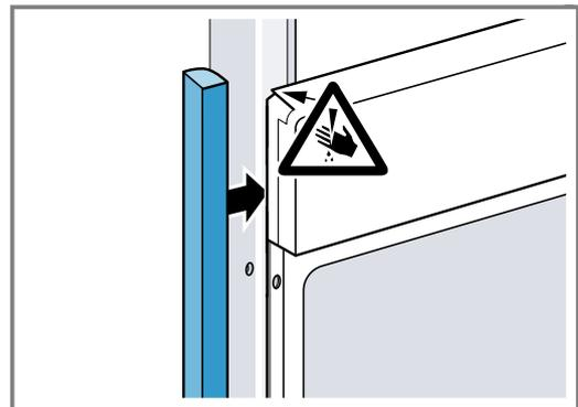
2. Aluprofile vorbohren, um eine Schraubverbindung herzustellen.
