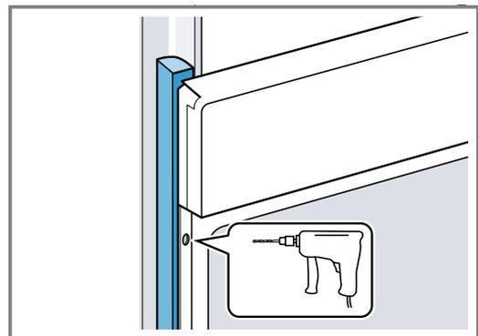
3. Gerät mit adäquater Schraube befestigen.
