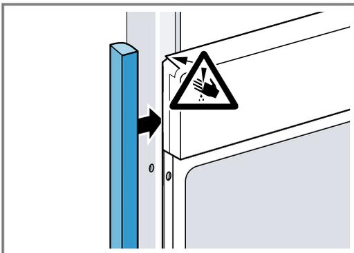
2. Aluprofile vorbohren, um eine Schraubverbindung herzustellen.
