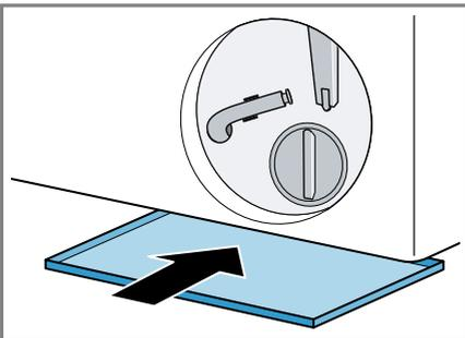
6. Den Entleerungsschlauch aus der Halterung nehmen.
