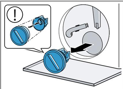
Der Pumpendeckel besteht aus zwei Bauteilen die zur Reinigung
