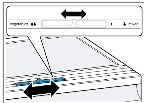
Podešavanje vlažnosti vazduha u posudi za voće i povrće u skladu sa vrstom i količinom namirnica koje treba skladištiti pomoću pomeranja regulatora za vlažnost:
