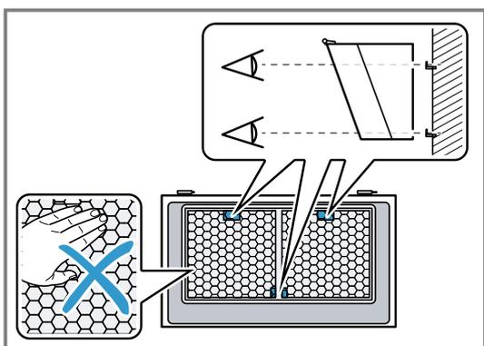
5. Um das Gerät auszurichten, das Gerät bei Bedarf von oben mit einem Schraubendreher in der Höhe justieren.
