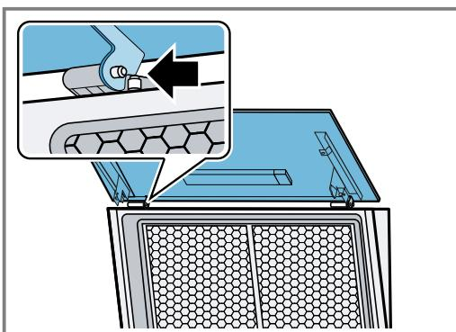
Stekleno ploščo trdno držite, dokler se ne zaskočita oba tečaja.
