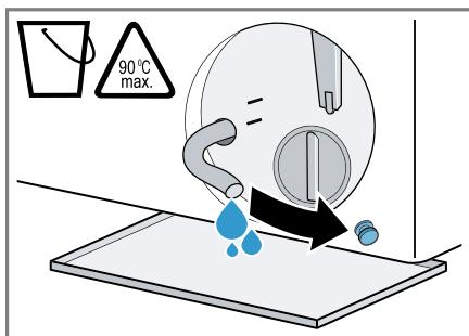
8. Appuyez sur le bouchon de fermeture.
