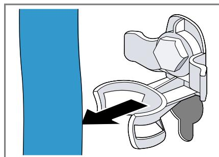
2. Dévissez les 4 vis des cales de transport à l'aide d'une clé à vis de calibre 13 ① et retirez-les ②.
