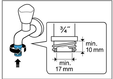
1. Den Wasserzulaufschlauch am Wasserhahn (26,4 mm = 3/4") anschließen.
