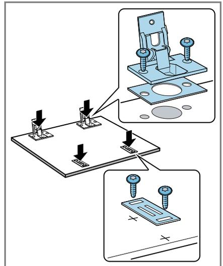
5. Die Gegenplatten der Magnetschnapper anschrauben.
