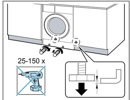
8. Das Gerät mit einer Wasserwaage ausrichten.
