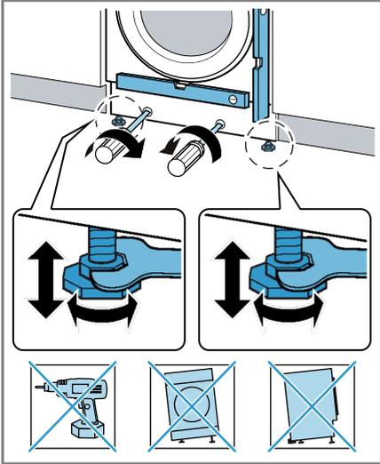
9. Die Kontermuttern der vorderen Gerätefüße mit einem Schraubenschlüssel der Schlüsselweite 17 handfest gegen das Gehäuse festziehen.
