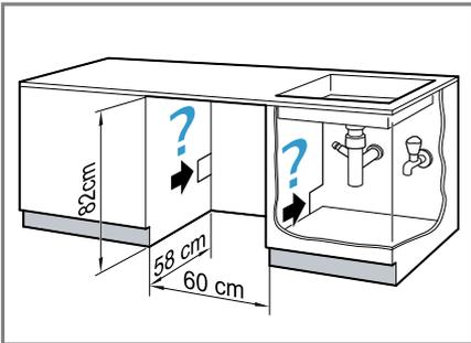
3. Die Netzanschlussleitung sowie den Wasserzulauf- und den Wasserablaufschauch verlegen.
