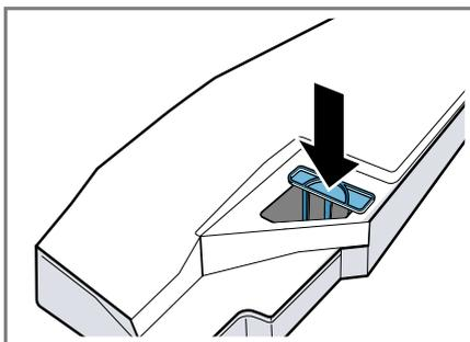
5. Insira o depósito da água de condensação.
