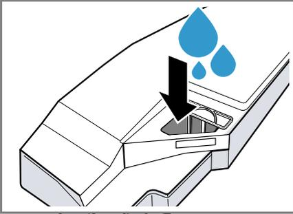
Mantenha o depósito da água de condensação cheio na horizontal, para que não possa sair líquido.
