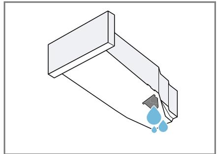
6. Insira o depósito da água de condensação até encaixar.
