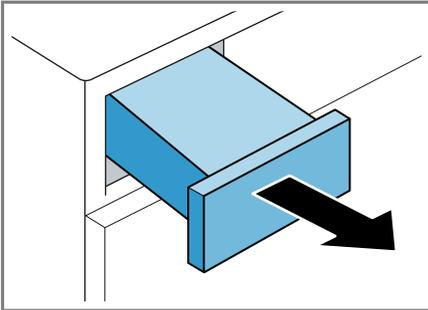
6. Encher o depósito da água de condensação com aprox. 1,5 litros de água quente.
