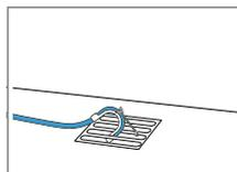
Empurre a mangueira de escoamento de água por completo através do e fixe-a com o material de fixação. Fixe o cotovelo no esgoto.
