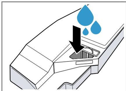
Mantenha o depósito da água de condensação cheio na horizontal, para que não possa sair líquido.
