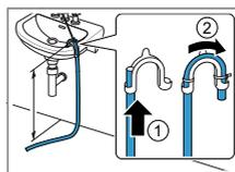
Empurre a mangueira de escoamento de água por completo através do e fixe-a com o material de fixação. Fixe o cotovelo a uma altura máxima de 100 cm.
