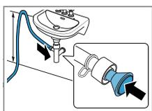
Fixe o ponto de união com uma braçadeira da mangueira (12-22 mm). Fixe o mangueira de escoamento de água com
