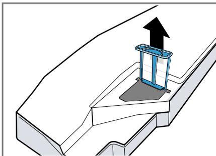
3. Limpe o filtro com água quente corrente ou na máquina de lavar louça.
