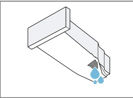
Pravidelne kontrolujte filter nádržky na skondenzovanú vodu → *Strana 42* a znečistený filter vyčistite.
