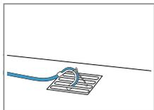
vody úplne zasuňte cez a zafixujte ju pomocou upevňovacieho materiálu. Oblúk upevnite na vpust.
