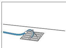
Crevo za odvod vode gurnite direktno kroz i fiksirajte ga pomoću materijala za pričvršćivanje. Pregib pričvrstite na kanalizacioni odvod.
