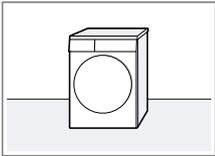
Uređaj postavite na čistu, ravnu i čvrstu površinu. Centrirajte uređaj → *Stranica 16.*
