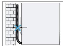
Nemojte da uglađujete creva i kabl za napajanje između zida i uređaja.
