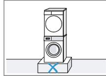
Ovaj uređaj postavite u stub sa mašinom za pranje i za sušenje veša samo sa setom za povezivanje proizvođača mašine za sušenje veša.
