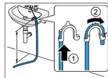
Crevo za odvod vode gurnite direktno kroz i fiksirajte ga pomoću materijala za pričvršćivanje. Pregib pričvrstite na maksimalnoj visini od 100 cm.
