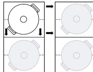
El recipiente es detectado y en el indicador de la nueva zona de cocción parpadean alternativamente el nivel de potencia y **L**.
