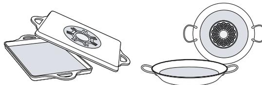
Fundos de recipientes para cozinhar com partes de alumínio reduzem a área ferromagnética. Isto pode reduzir a potência de saída e o recipiente para cozinhar só é insuficientemente detetado ou não o é de todo e, portanto, não é suficientemente aquecido.
