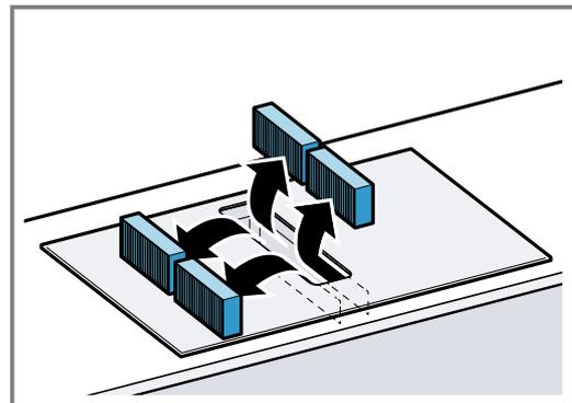
5. Coloque os 2 filtros de odores ou acústicos do lado esquerdo e direito no aparelho e empurre para a frente.
