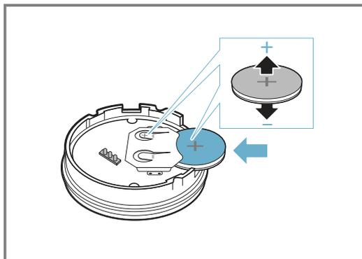
**Hinweis:** Keine Gegenstände aus Metall verwenden, um die Batterie zu entfernen. Die Batterieanschlusspunkte nicht berühren.
