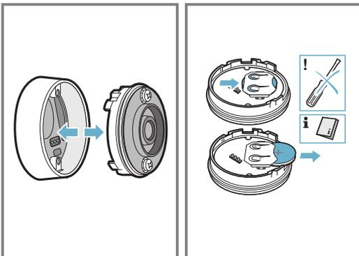
3. Eine neue Batterie einsetzen und dabei die Anweisungen zu den Batteriepolen beachten. Nur hochwertige Batterien des Typs CR2032 verwenden.
